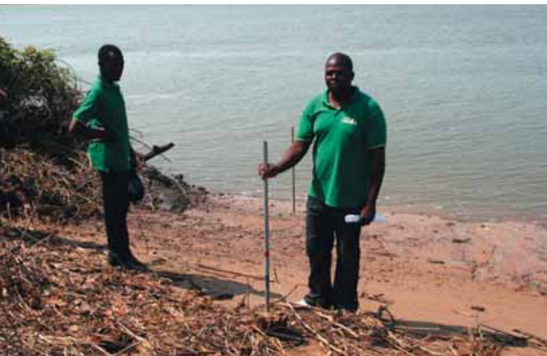
Ein ehrenamtlicher Warnbeauftragter liest an einfachen Stangen mit Farbmarkierungen den Wasserstand des Buzi ab. Foto: Administration District Govuro
