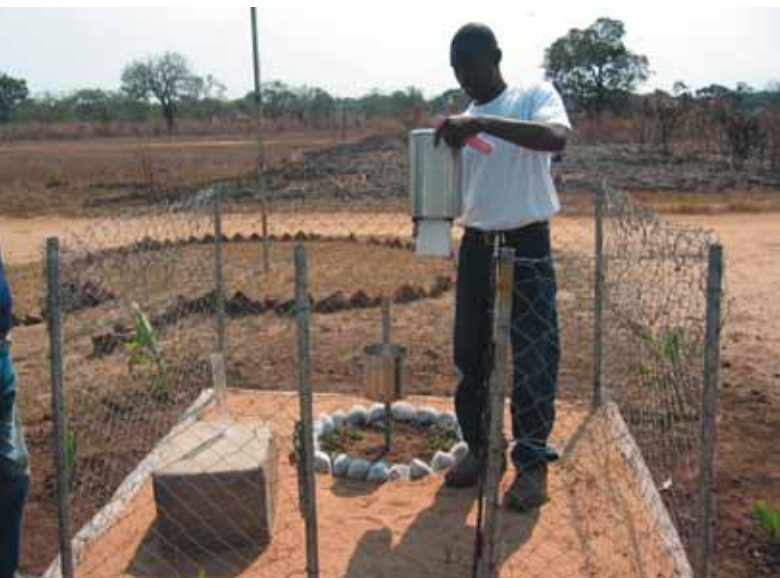
Wassermessstation mit Trainer: Das Flutwarnsystem, das deutsche Experten am Oberlauf des Buzi aufgebaut haben, setzt auf die Mitarbeit der dörflichen Bevölkerung. Ein Messbeauftragter bestimmt mit Hilfe eines Metallzylinders die gefallene Regenmenge. Foto: Thomas Loster
